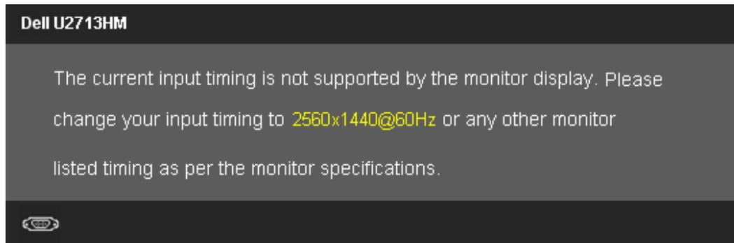
Indica che il monitor non è in grado di sincronizzarsi con il segnale che riceve dal computer. Si veda [Specifiche monitor](#) per avere le frequenze Verticali e Orizzontali utilizzabili da questo monitor. La modalità raccomandata è 2560 x 1440.
